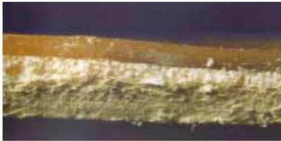
*Sezione di un rivestimento usato per i pavimenti dei treni: lo strato inferiore è in cartone di amianto*
