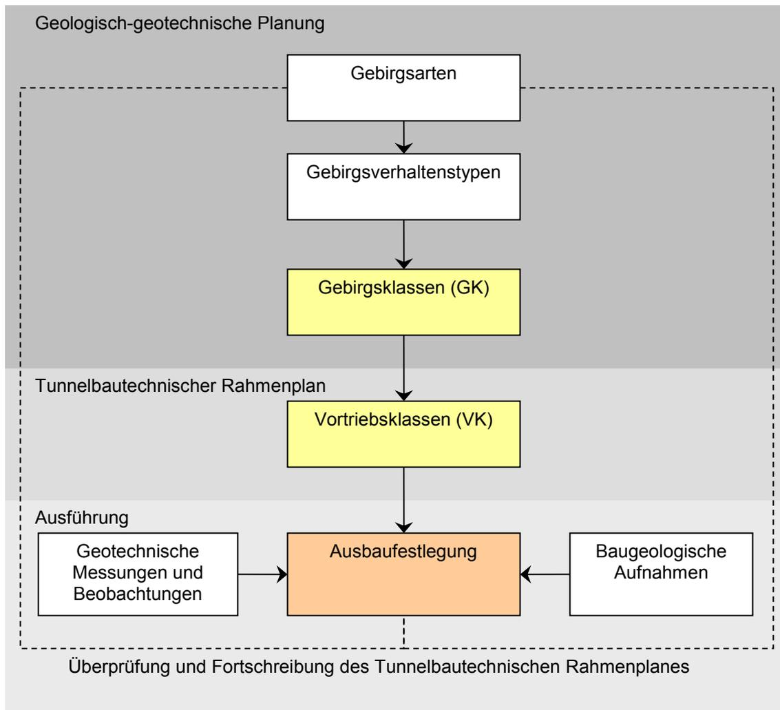
**Bild 1: Schematischer Ablauf**
