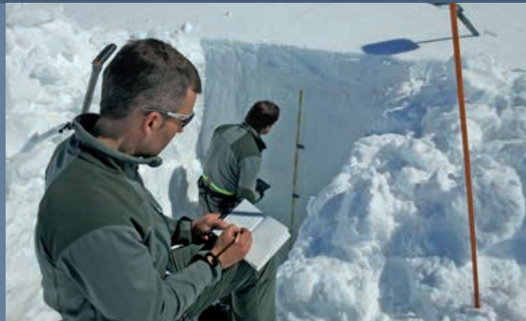
Schacht zur Erhebung der Dichte und der Schichtung des Schnees Trincea per il rilievo della densità e della stratificazione della neve
