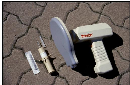
**Abb. 7: Material für die individuelle Markierung mit Mikrochip:** (v.l.n.r.) steril verpackte Injektionsnadel, Injektionspritze und Lesegerät.
