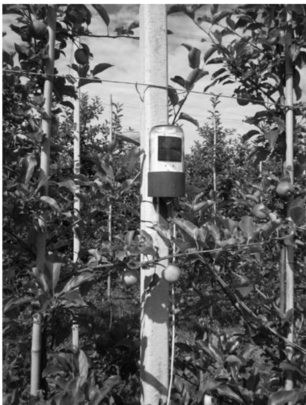
*Fig. 1: Centralina per l'irrigazione mirata, basata su tecnologia aperta 'Arduino'*
