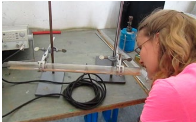
Stehende Schallwellen werden im Kundtschen Staubrohr sichtbar gemacht.
