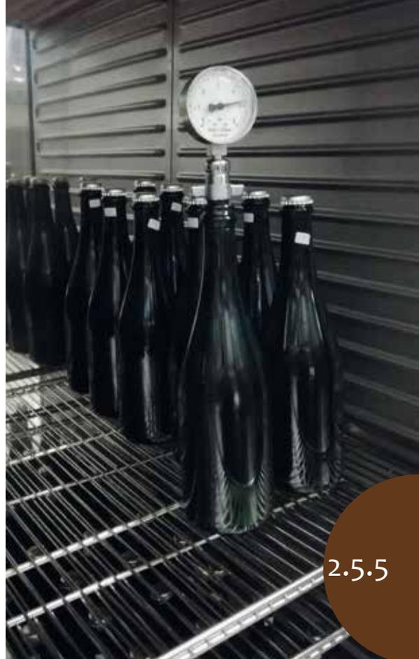
Fig. 1: Bottiglie di sidro durante la rifermentazione, con bottiglia munita di afrometro utilizzato per monitorare l'innalzamento della pressione dovuto allo sviluppo di anidride carbonica.
