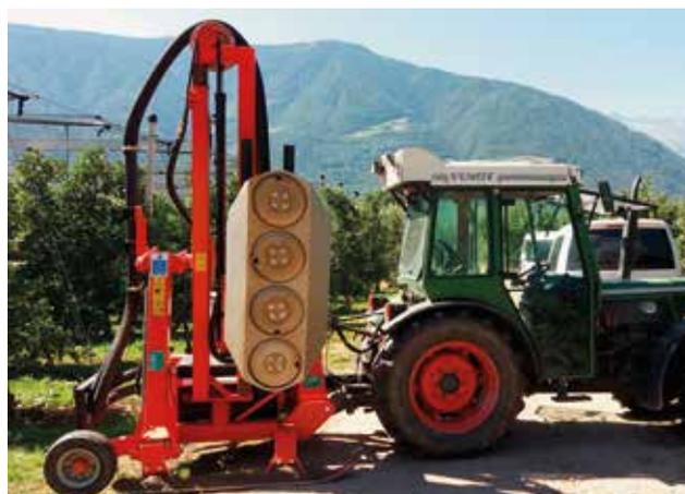
Im Agrarbetrieb wird eine neue Methode erprobt, um das Färben der Früchte zu fördern. Beim Entblättern mit Druckluft wird jede Baumreihe mit einer pneumatischen Entblättermaschine, die am Schlepper angebaut ist, abgefahren. Dabei werden vor allem die Blätter, die die Früchte verdecken, durch die Luftstöße entfernt, sodass die Äpfel in den letzten Tagen vor der Ernte mehr Licht bekommen und die gewünschte Farbe ausbilden.
