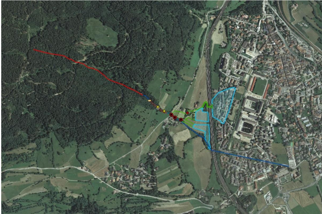
Abbildung 4: Nachträgliche Rekonstruktion der Überflutungsdynamik des Riesenbachs infolge der starken Niederschläge vom August 2012 (Quelle: Ereignisdokumentation – ED30)
