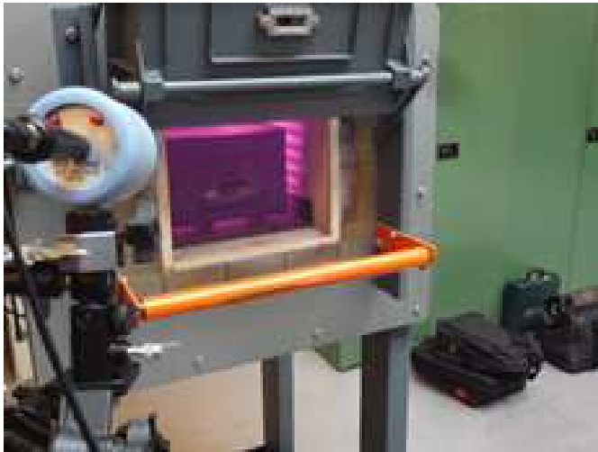
Ofen für Metall Öffnung bei eingeschaltet Ofen >> mittleres Risiko
